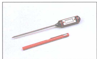
③ 温度计 用来测量水温或面团温度。
