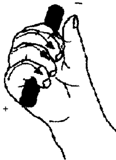
图 1-10 右手定则确定磁力线方向示意图
