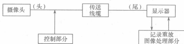
图 1-1 电视监控系统的组成
