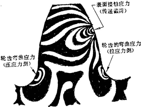
图 1.1.8 承载的渐开线轮齿中的主应力区的光弹测定照片
