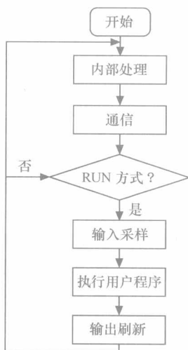
图 1-2 PLC 循环扫描工作方式
