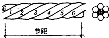
图6-3 钢丝绳节距的量法 1~6—钢丝绳绳股的编号
