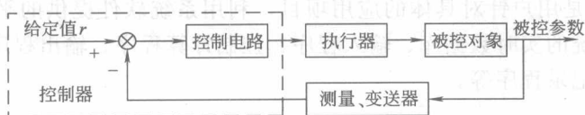
图 1-1 典型的常规过程控制系统结构
