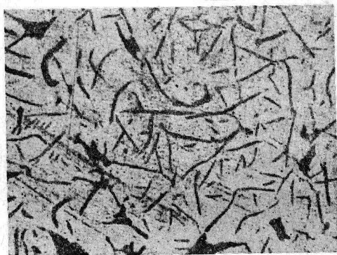
圖1：片狀石墨灰鑄鐵磨光未浸蝕放大 100 倍
