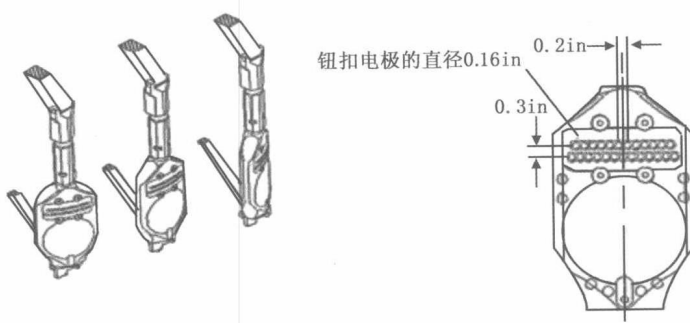
图 1-4 EMI 仪器极板结构和电极尺寸示意图
