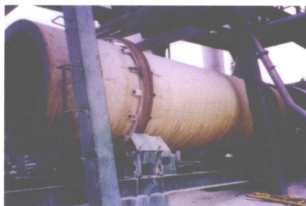
我公司为广州市政维修处沥青混凝土拌厂制造安装中的烘干筒
