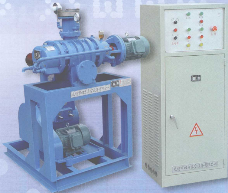
↑ JZJX 型罗茨泵旋片泵机组
