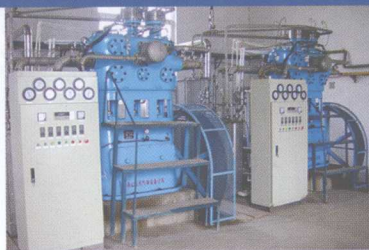
250m³/h 高压氧气压缩机
