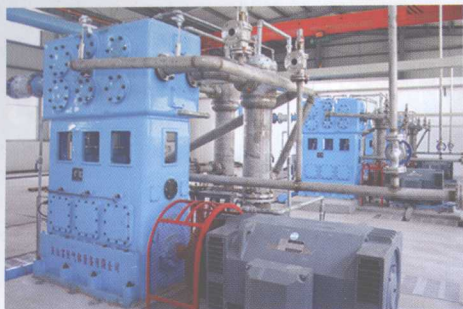
550m³/h 中压氧气压缩机
