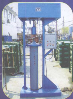
◇ 气瓶胶圈装卸机
