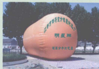
中国航天集团总公司下属新天动力公司 正在使用300m 3 超高分子贮气囊
