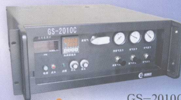
GS-2010C 型 在线总烃分析仪
