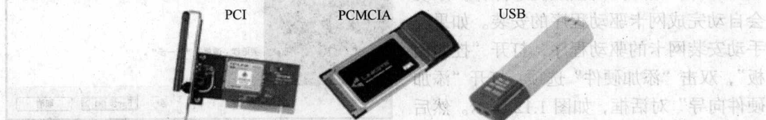
图 1.10 PCI、PCMCIA 和 USB 无线网卡
