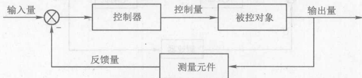
图 1-5 闭环控制系统结构原理框图
