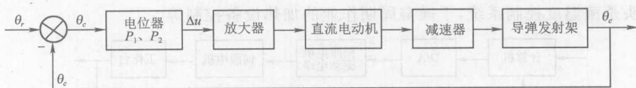
图 1-11 导弹发射架方位角控制系统原理框图
