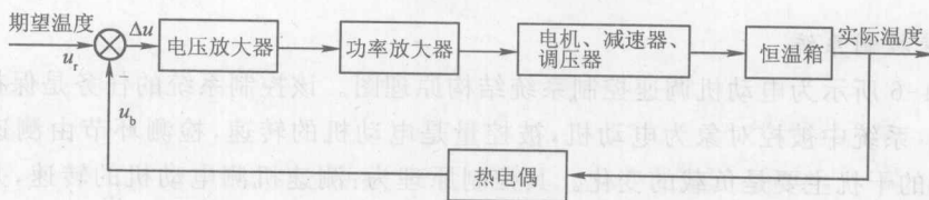
图 1-9 恒温箱系统原理框图
