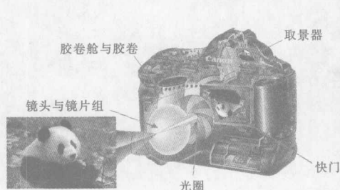
图 1-1-1 胶片照相机的基本结构
