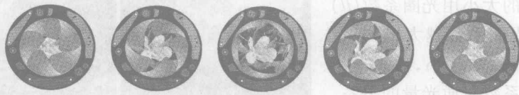
图 1-1-5 镜间快门的开启与闭合过程
