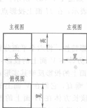
图 1-8 三视图度量关系
