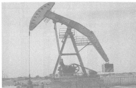
(b) CYJQ14-5-73HY 调变径游梁平衡抽油机
