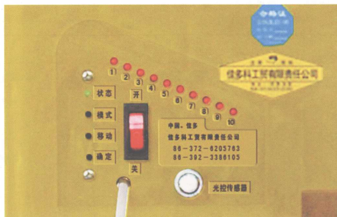
图5 佳多频振式杀虫灯分时诱杀控制模块
