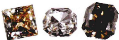
图 4 Apollo 公司 CVD 法合成的 0.25 克拉钻石
