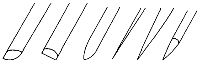
图 1-3 电烙铁头形状
