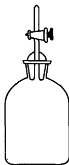
图实 1-3 真空采气瓶
