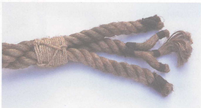
每根大缆是由3根绳以左手系（S形）拧成。每根绳又是由3股子绳以左手系拧起来而成。而每股子绳则是由无数根植物纤维纺成的子线以右手系（顺时针）拧成的。
