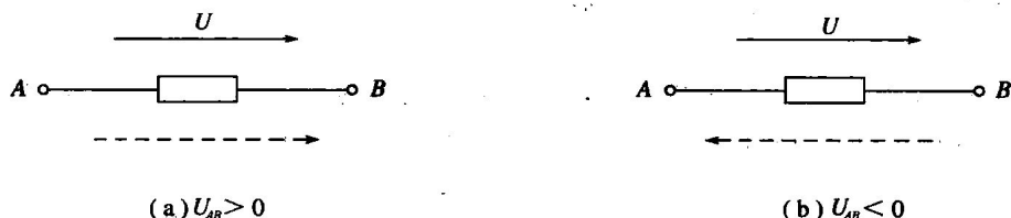
图 1.5 电压的参考方向与实际方向的关系
