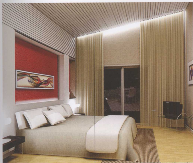
— 石膏板造型吊顶 —
