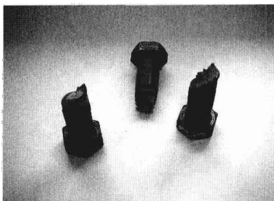
图8 断裂的连接螺栓
