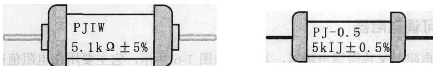
图1-3 电阻值的直标法实例
