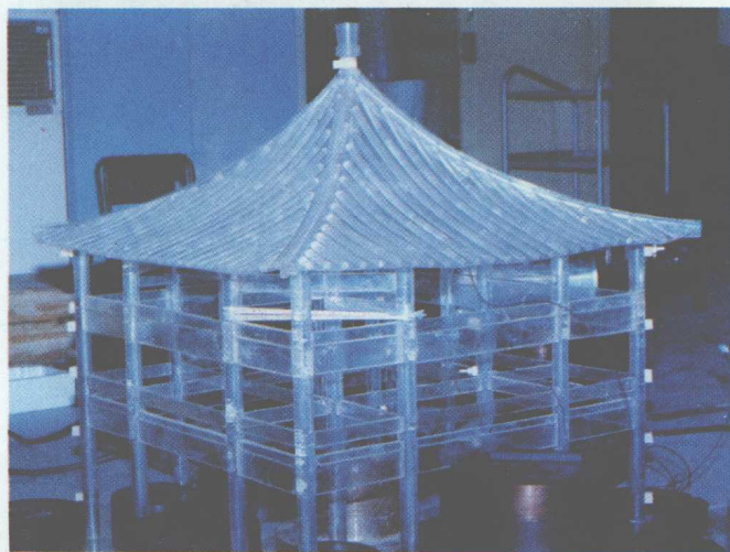
图版 19 钟楼无损振动试验的传感器安装 茂宏摄
