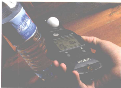
在闪光灯下拍摄，曝光模式应调整为手动(M)挡，快门速度需调整为1/250秒的同步速度或略低，如1/125秒，并将闪光灯测光表也调整为该速度。将该表放在被摄体前，对着相机，按下测光钮直至闪光灯闪过，表上显示的值即为拍摄所需的光圈值。
