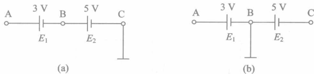
图 1-16 电位与参考点的关系
