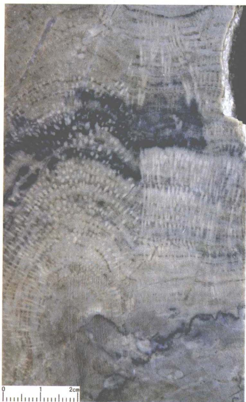
层孔虫格架岩。塔中 822 井，5700.01m，上奥陶统良里塔格组，岩心
