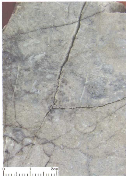
苔藓虫障积岩。塔中 24 井，4519.55m，上奥陶统良里塔格组，岩心
