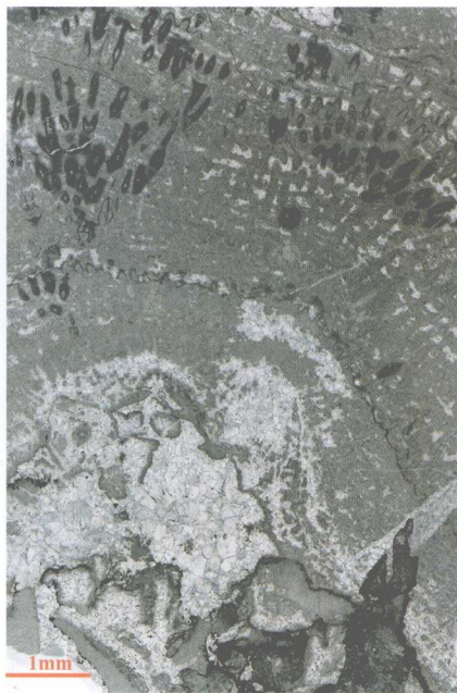
层孔虫格架岩。塔中 826 井，5700.5m，上奥陶统良里塔格组，超大薄片
