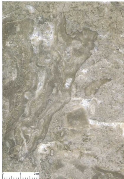
层孔虫格架岩。塔中 822 井，5710.82m，上奥陶统良里塔格组，岩心
