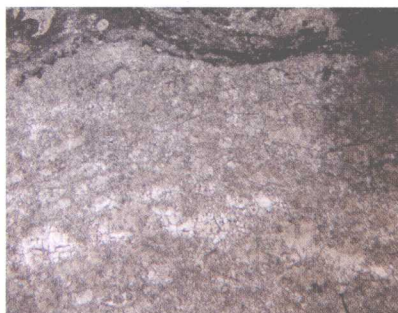
层孔虫格架岩。塔中 822 井，5612.82m，上奥陶统良里塔格组，单偏光， \times 12.5
