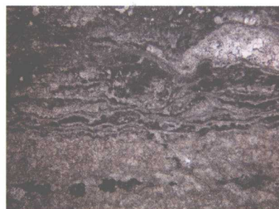
层孔虫格架岩。层孔虫格架间球松藻粘结，塔中 822 井，5612.82m，单偏光， \times 12.5
