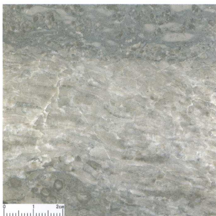
层孔虫格架岩 + 生屑石灰岩。塔中 822 井，5716.35m，上奥陶统良里塔格组，岩心
