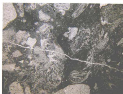
格架间的生屑、灰泥、隐藻粘结。塔中 242 井，4514.94m，单偏光， \times 12.5
