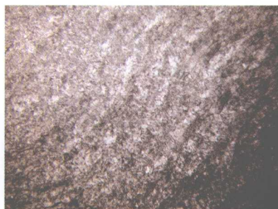
层孔虫格架岩。玛 401 井，2295.22m，上奥陶统良里塔格组，单偏光， \times 12.5
