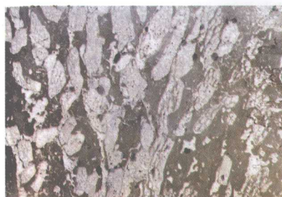
珊瑚斜切面, 珊瑚间为灰泥充填。塔中 72 井, 5059.80m, 上奥陶统良里塔格组, 单偏光, \times 25
