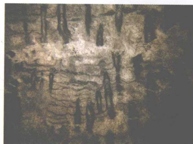
层孔虫格架岩。塔中 822 井，5700.01m，上奥陶统良里塔格组，单偏光， \times 10
