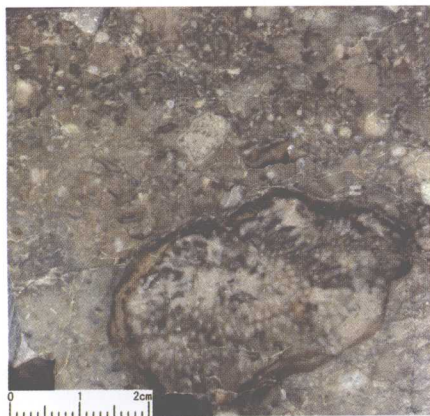
苔藓虫障积岩。塔中 72 井，5063.80m，上奥陶统良里塔格组，岩心
