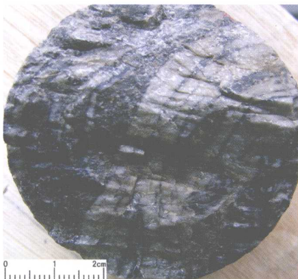
层孔虫格架岩。塔中 62-3 井，4848.7m，上奥陶统良里塔格组，岩心
