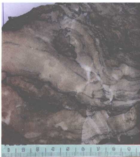
层孔虫格架岩。玛 401 井，2295.22m，上奥陶统良里塔格组，岩心
