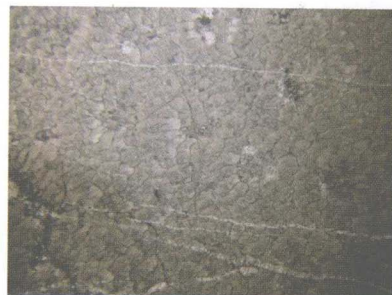
层孔虫格架岩。塔中 242 井，4514.94m，单偏光， \times 12.5
