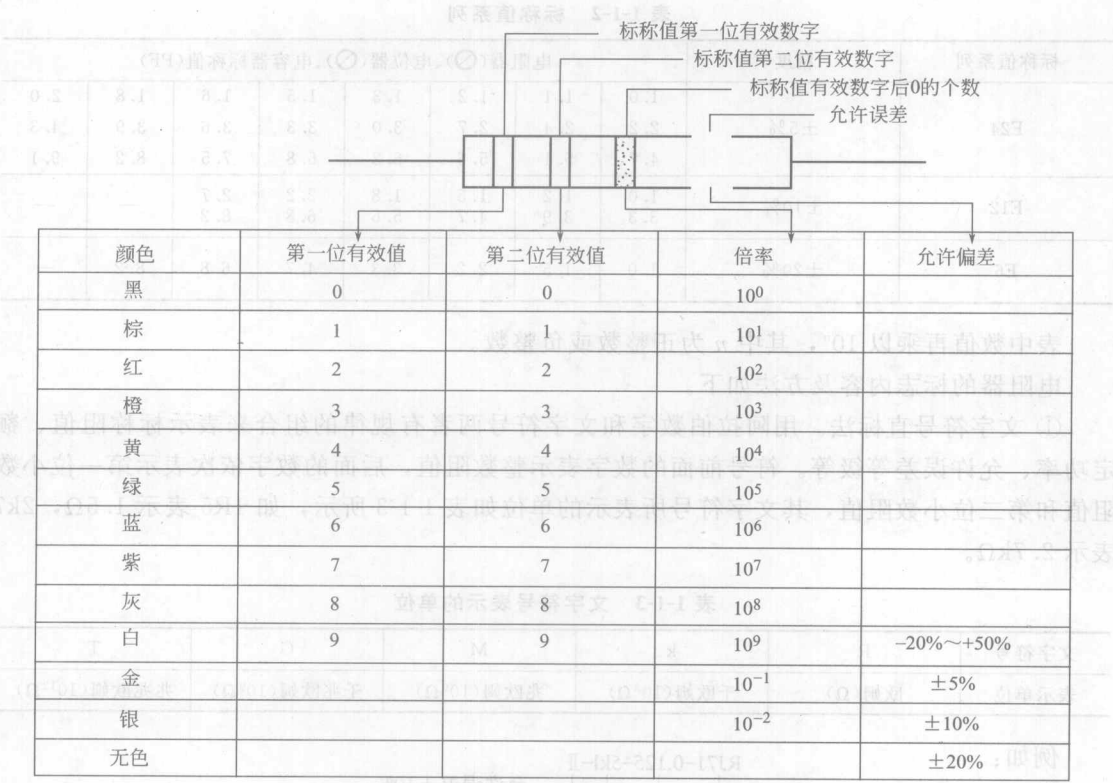
图 1-1-5 两位有效数字阻值的色环表示法
