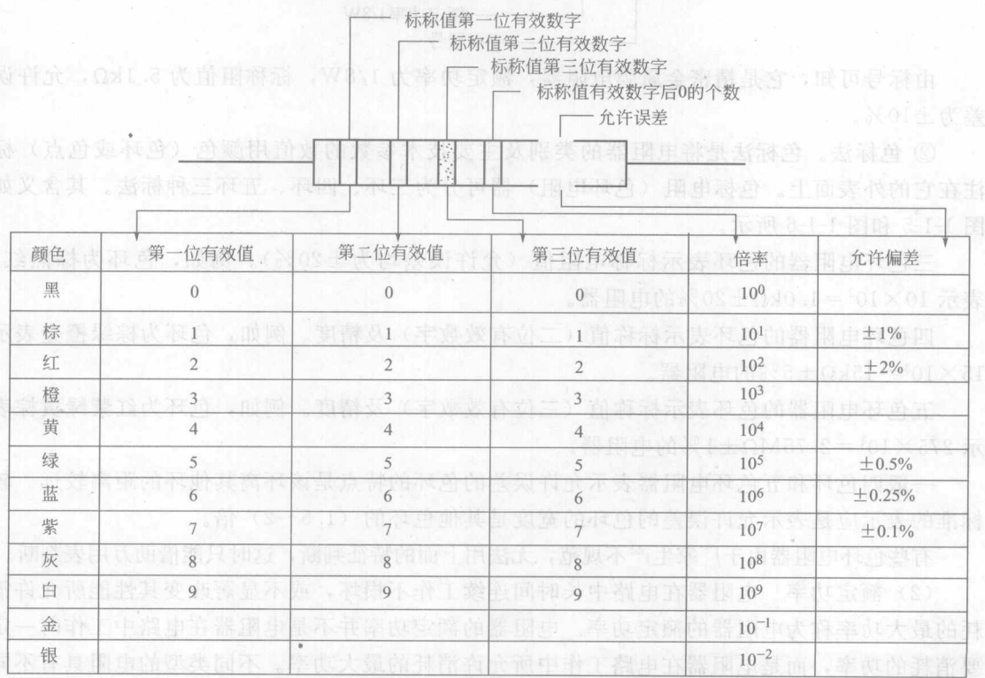
图 1-1-6 三位有效数字阻值的色环表示法
