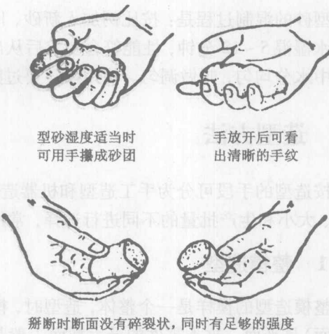
图1-3 手攥法检验型砂
