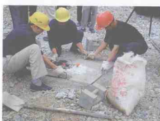
附加质量法堆石干密度检测作业准备
