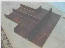
周边缝内一次成型铜止水“T”型接头
