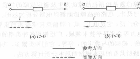
图 1.2-1 电流的参考方向
