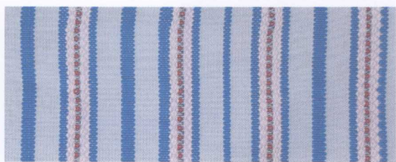
图3-3 经重平与平纹组织联合纵条纹织物
