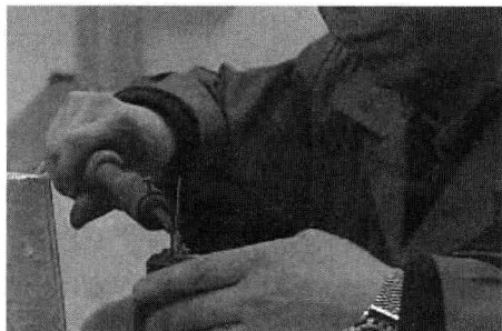
图 1-12 用外热式电烙铁焊接较大的元器件
