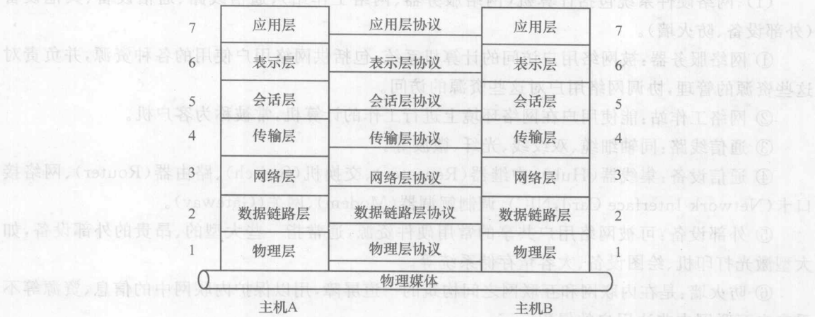
图 1-1-3 OSI 参考模型及协议
