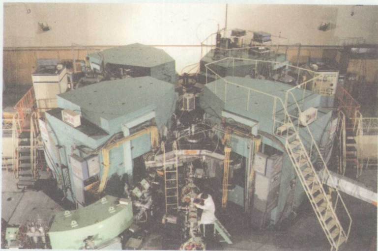
◎ 新核素合成和研究中使用的兰州重离子加速器
