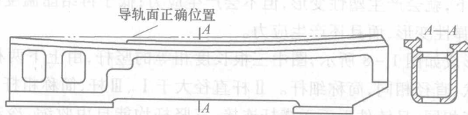
图 1-9 车床床身挠曲变形
