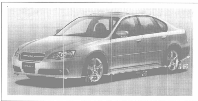
图 1-6 汽车的三个组成部分
