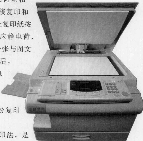
还有一种更加方便的间接复印法，是在由硒材料制成的“硒鼓”上，先形成静电图像，让墨粉吸附在上面，再转印到复印纸上去，形成复印件。采用这种复印方法，对复印件没有别的要求，即使是普通纸张也能复印出来。
