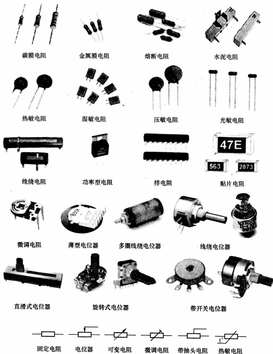
图 1.1 常用电阻器、电位器的实物图及图形符号
