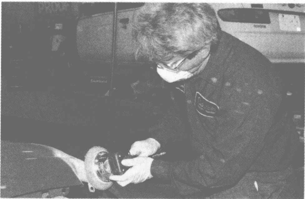
图 1-4 车身技师正在用气动打磨机磨平凹陷车身上的车身填料
