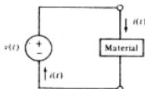
高 1 V。因此材料內部的電子會從底端流到頂端，也就是電流從頂端流向底端。此時  $v(t)$  為正值， $i(t)$  亦為正值，亦即電流如圖示的方向。當  $t = 1$  秒時， $v(t) = 2\text{V}$ ，材料頂端的電位仍高於底端，所以  $i(t)$  仍為正值，但因電位差是  $t = 0$  秒時的兩倍，所以  $t = 1$  秒時的電流比  $t = 0$  秒時大（若此材料為“線性”元件，則電流也將增為兩倍）。當  $t = 2$  秒時， $v(t) = 0\text{V}$ ，亦即材料頂端的電位和底端相同，結果電子不會流動，不會產生電流， $i(t) = 0$ 。當  $t = 3$  秒時， $v(t) = -2\text{V}$ ，亦即材料頂端的電位低於底端，因此造成由底端流向頂端的電流，此時  $i(t)$  為負值。注意到電流  $i(t)$  也流過電壓源，因為電流完全沒有其他的分路。
