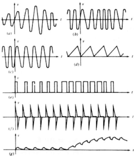
一些電壓波形的例子。圖 a 和圖 b 分別是典型的調幅 (AM) 和調頻 (FM) 信號。這兩種信號都用在民用的收音機通訊上。圖 c 上的弦波，用途非
