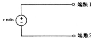
圖 1-1 的裝置，端點 1 上標有正 (+) 號，端點 2 則標負 (-) 號，這表示端點 1 的電位高於端點 2，且差額為  $v$  伏（也可以說，端點 2 的電位較端點 1 低  $v$  伏）。
