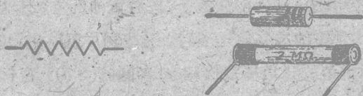
圖 109 固定電阻器的符號和實物。
