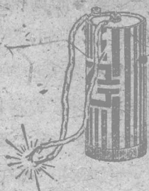
圖 108 電池接線的兩端不要相碰，否則電池就要自行大量放電而損壞。
