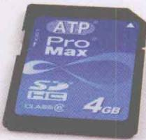
数码相机的主要存储介质分为4种形式：CompactFlash（CF卡）、SmartMedia（SM卡）、Secure Digital Memory Card（SD卡）、MemoryStick（记忆棒）。其中CF卡也被称为“微型闪存卡”，其以通用性著称，在扩展性上具有更大的优势，容易适应高分辨率高质量数字图像的存储工作；SM卡是最早应用在数码相机上的存储介质之一，以小巧轻薄闻名，但是价格较前者昂贵，目前只有少数数码相机支持SM卡；SD卡是一种基于半导体快闪记忆器的新一代记忆设备，具有体积小巧，传输安全，格式化方便，容量大，性价比高等优点，目前被广泛应用于各类手机、数码相机等设备中；记忆棒又称SONY记忆棒，最大的优点是可以跨平台使用，但由于是SONY数码产品的专用存储介质，所以兼容性不佳。存储介质的容量当然越大越好，因为存储量越大，数码相机所拍摄的照片数量就越多而不用频繁输出。现在市场上绝大部分数码相机都配16MB或32MB容量的存储介质，无法满足在高分辨下的拍摄工作，需要我们至少再多配一张更大容量的卡。
