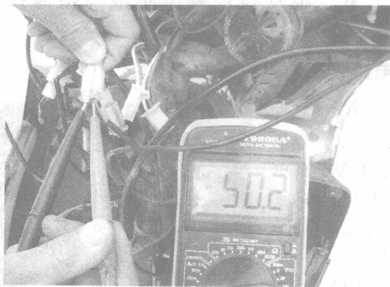
图 2-7 闸把开关的电源电压的测量
