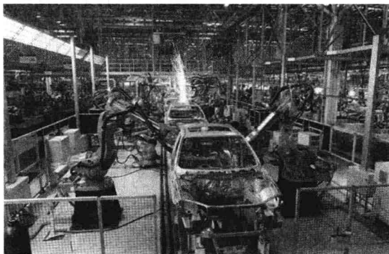
图 1-1-3 计算机机器人控制的汽车生产线
