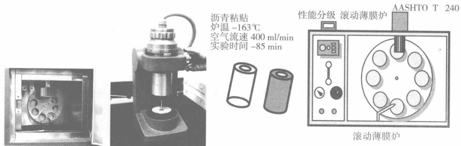
图 12 沥青粘性测定设备示意图
