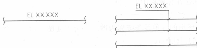
图 1-10 在平面图管道标高的标注方式
