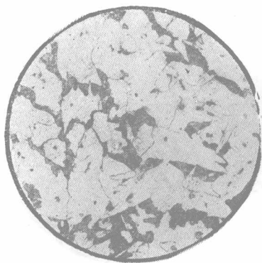
〔金相图 5〕 放大105倍。 4 % 硝酸酒精溶液浸蝕； 显微組織：鉄素体+层状珠光体。
